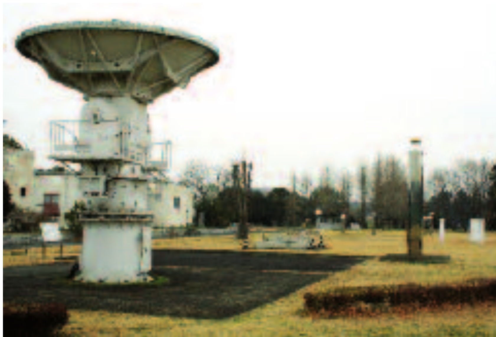
Stations Station du réseau GPS permanent (colonne de droite) et antenne VLBI (à gauche) du centre GSI à Tsubaka (Japon).
