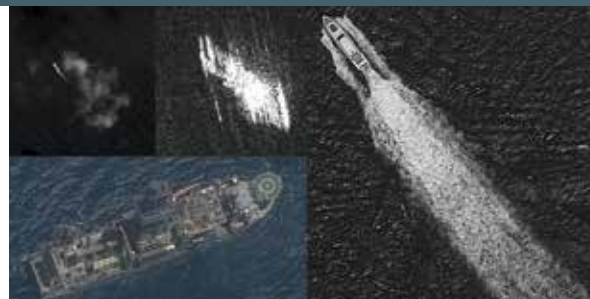
▲ Approche multi-échelle pour la détection de navires par télédétection spatiale optique et RSO
