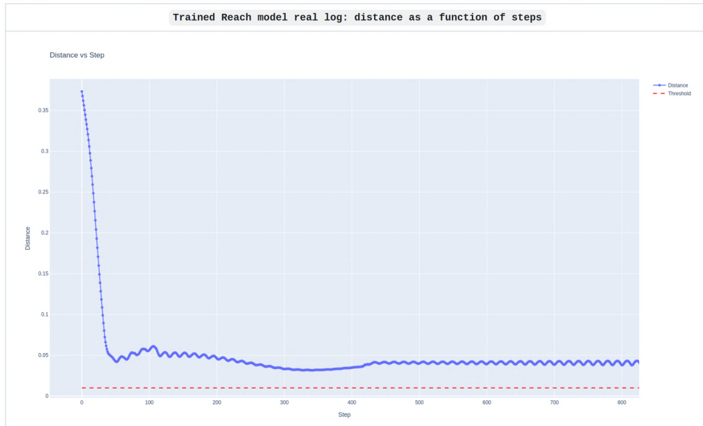
FIGURE III.15 – Expérimentation réelle du bras xArm6 entraîné pour la tâche Reach : Graphique de la distance à l'objectif en fonction des pas d'expérience
