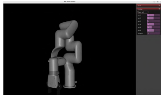
FIGURE III.9 – Modèle 3D final du bras xArm6 sur MuJoCo
