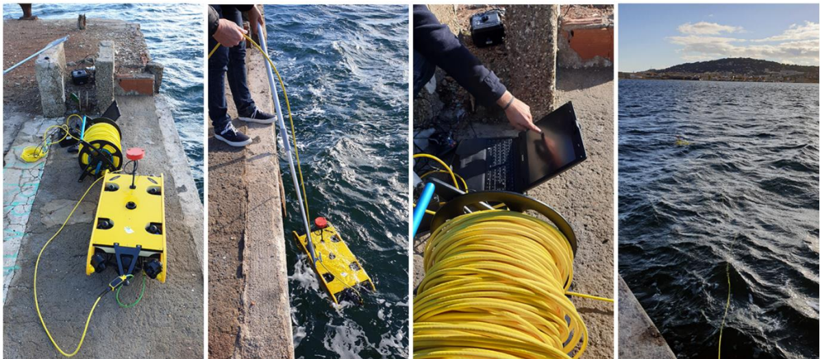
Annexe 9 Installation de la station sol, mise à l'eau (30 Kg !) et début des tests. Le premier consistait à la vérification du comportement lors de la perte d'un moteur, le deuxième à l'acquisition de la profondeur avec un sonar de type ping et le dernier à la mise en place du mode sécurité lorsque le robot arrive trop proche d'un obstacle
