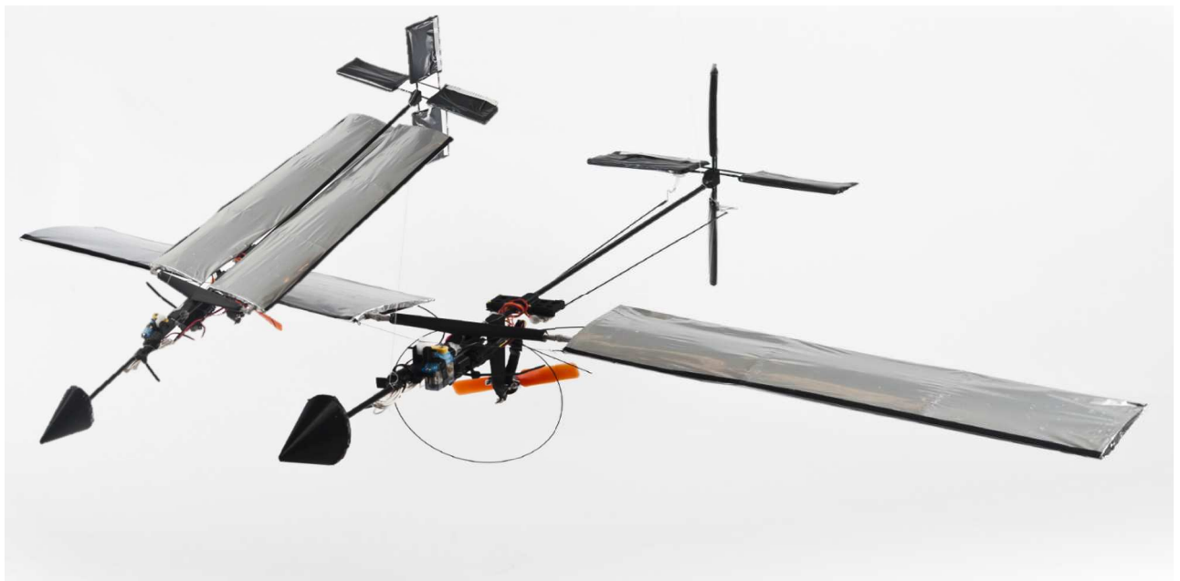
Figure 1 : un avion "plongeur" à ailes rétractables
