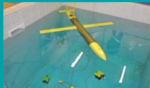
Bassin d'essais pour le calibrage des sondeurs acoustiques.
